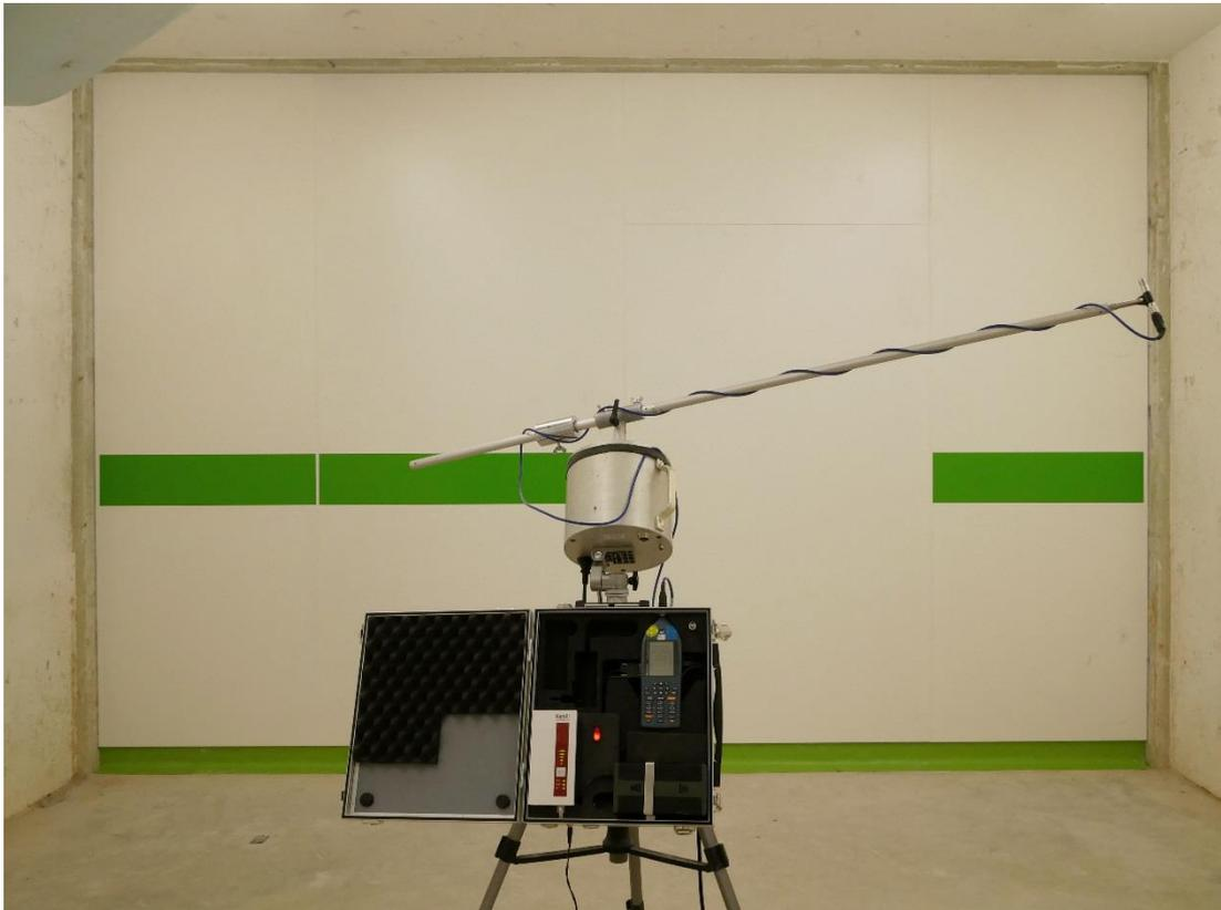
**Bild 1:** Variante 1 - **RooSy Wand 100 - 3-tlg.** im Wandprüfstand der HFT Stuttgart (mit Mikrofon-Schwenkanlage und Schallpegelmesser im Vordergrund)
