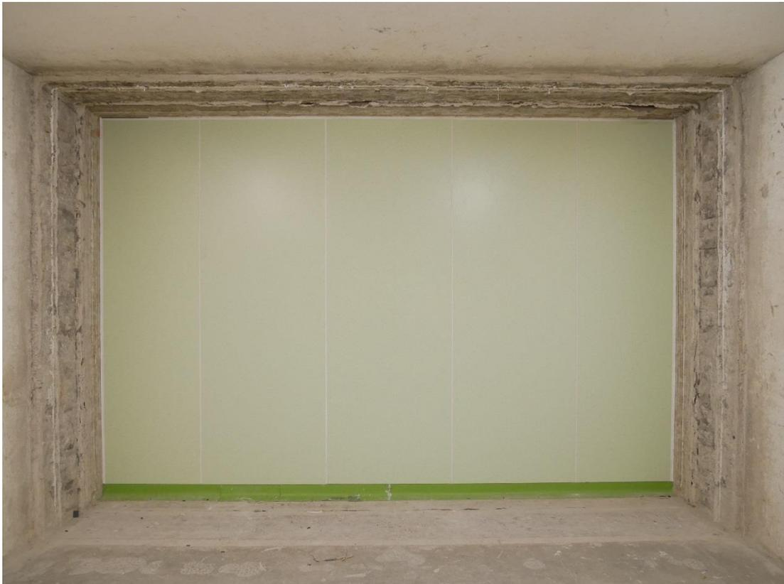
**Bild 3:** Variante 6 - RooSy Wand 100 - 1-tlg. im Wandprüfstand der HFT Stuttgart
