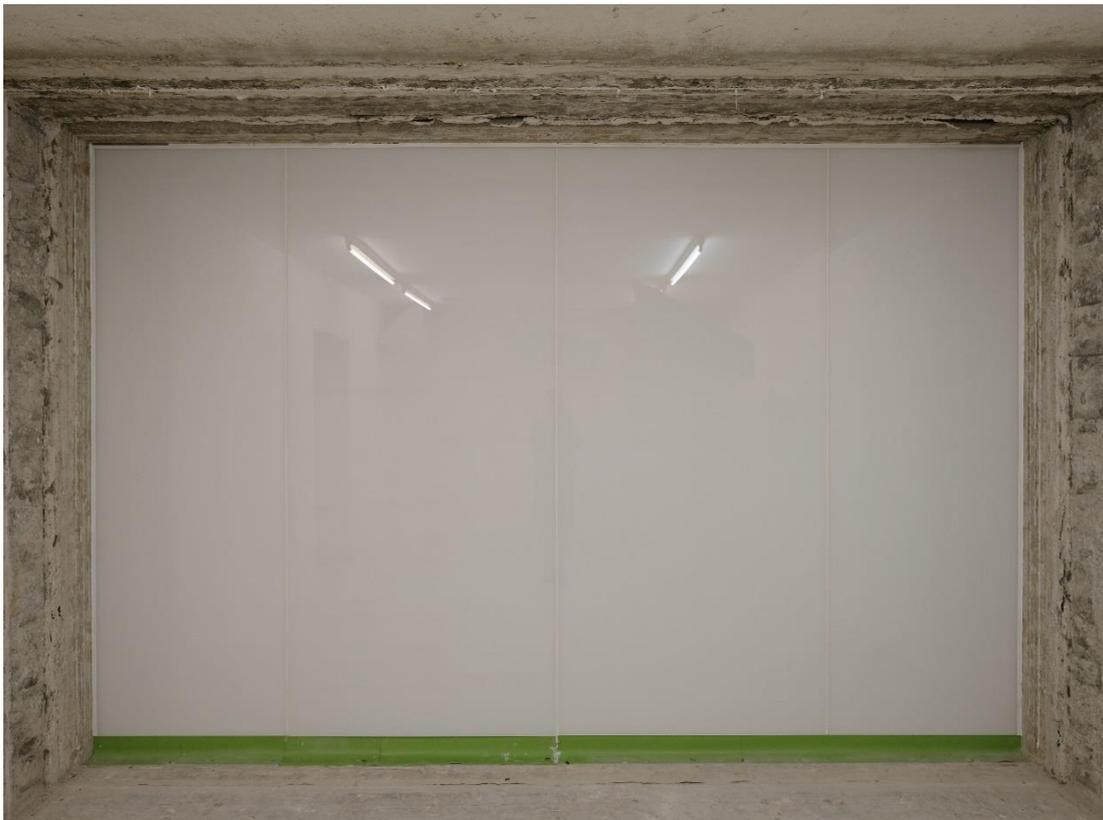
**Bild 2:** Variante 5 - **RooSy Glas-Wand 100 - 1-tlg.** im Wandprüfstand der HFT Stuttgart
