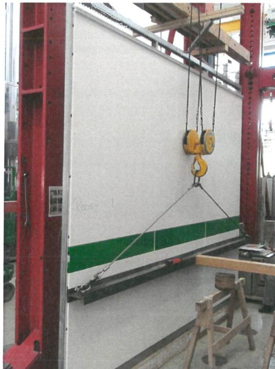
Bild 2: Vorderansicht der Trennwand, die Beplankungshöhe der Wand beträgt  $h = 3,00$  m
