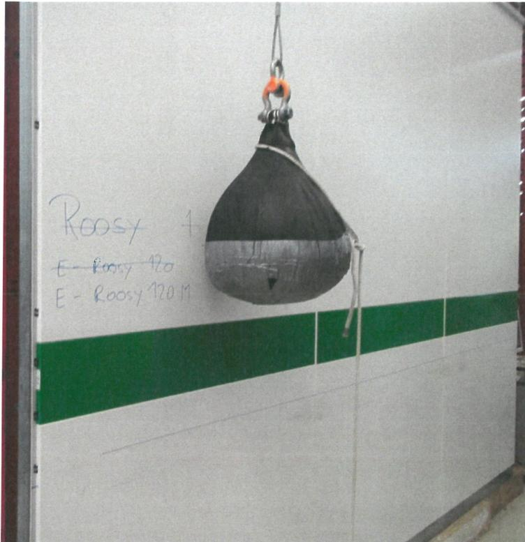
Bild 4: Versuchsaufbau der Pendelschlagprüfung,  $h = 1,50 \text{ m}$ , an der Trennwand
