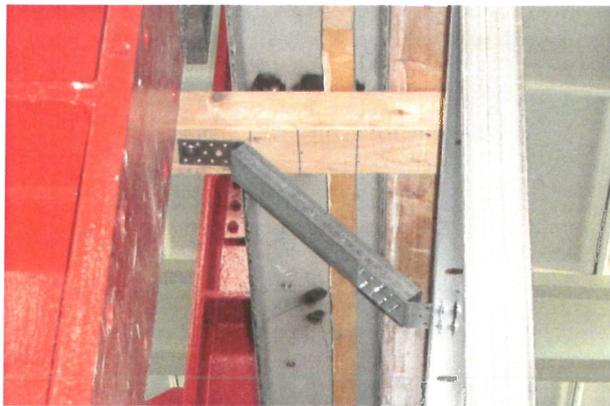
Bild 1: Zug- und druckfeste Montage der Wand am oberen Rand über zwei Winkel und ein Stahlprofil an die Querholme des Versuchsstandes
