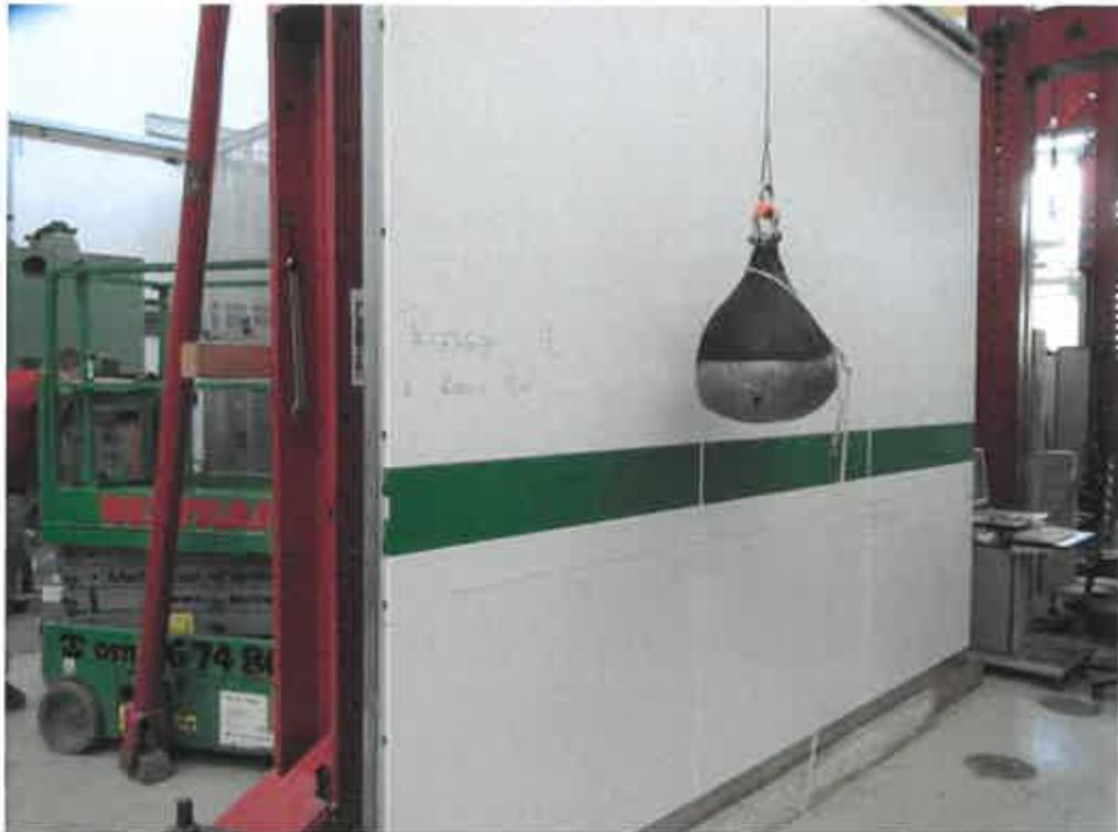
**Bild B.5.1:** Teilversuch, Pendelschlagversuch, Pendelschlagversuch direkt auf den Pfosten Nr. 2, an der linken Seite der Wand. Auftreffhöhe, gemäß ETAG 003,  $h = 1,50$  m. Pendelfallhöhe  $3 \times h = 24$  cm, Aufprallenergie  $3 \times E = 120$  Nm
