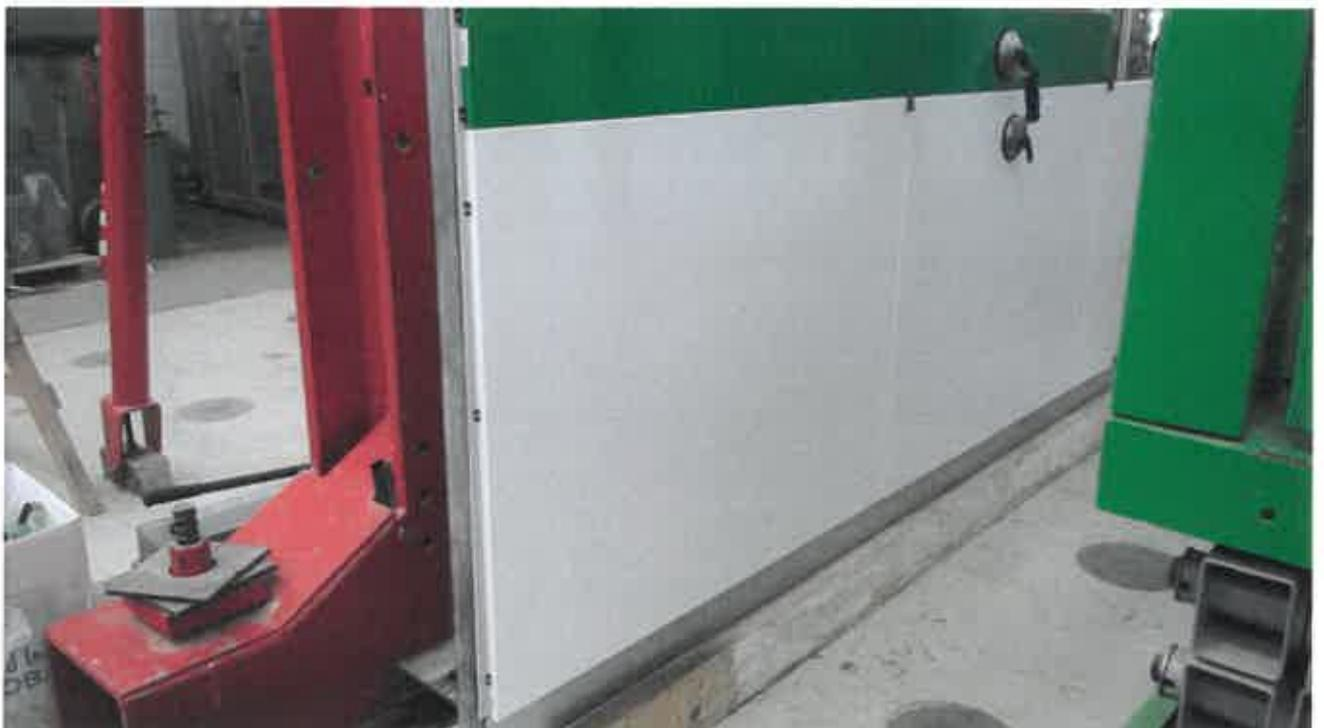
**Bild A.6.2:** Die Befestigungsklammern haben in der Regel einen Abstand von ca.  $e = 45 \text{ cm}$
