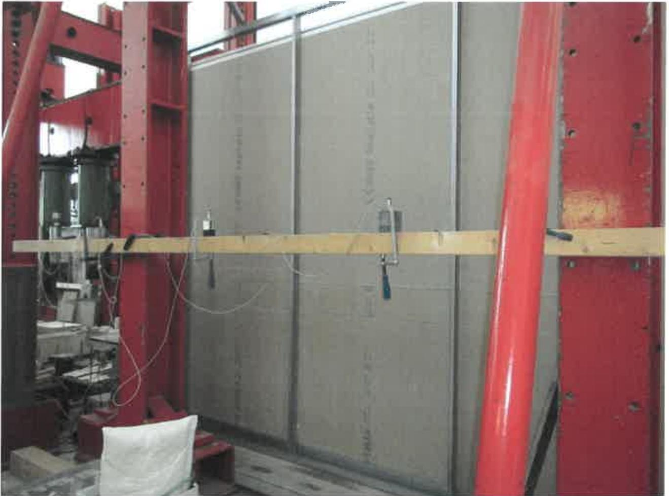
**Bild B.3.1:** Wegaufnahme Nr. 1 bis Nr. 3 an der Rückseite der Wand
