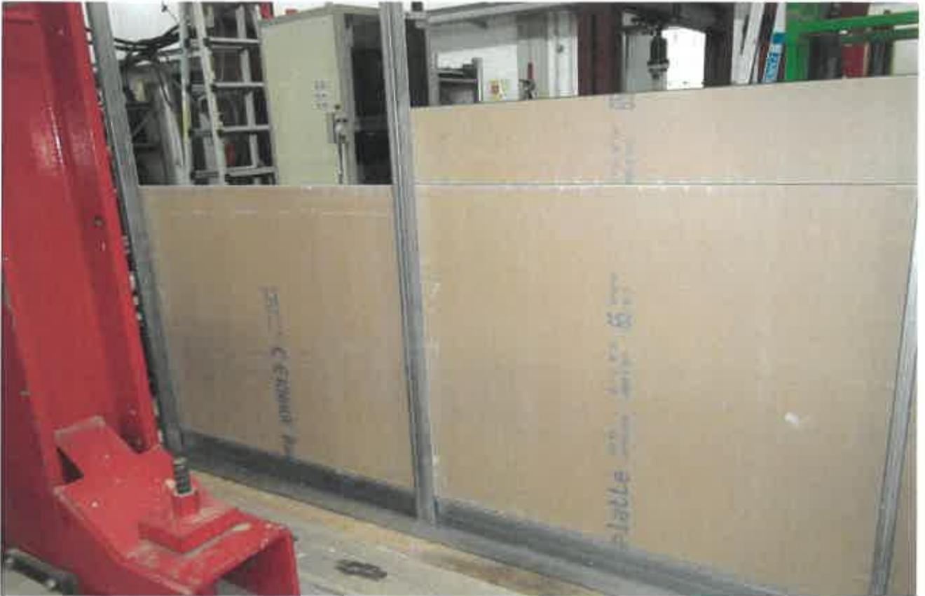
**Bild A.4.1:** Aufbau der Stützenprofile 60 x 30 x 2 im Raster  $e = 1,20$  m
