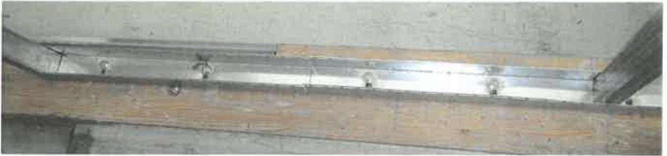
**Bild A.2.1:** Montage der U-Bodenschiene, H101-0022-02, durch den Auftraggeber auf der Fußbohle (#16/16), Versuchsstand der MPA Braunschweig
