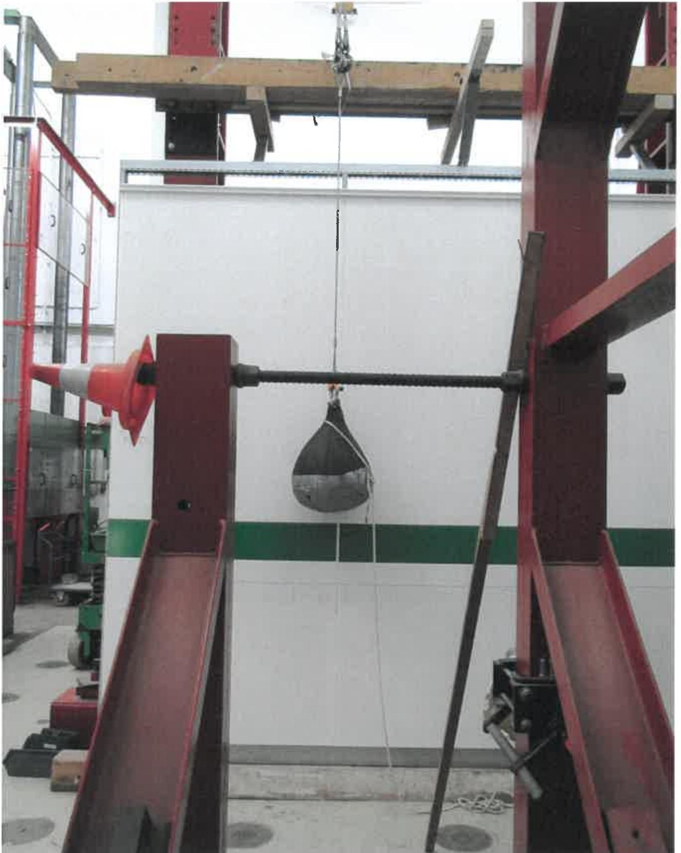
**Bild B.8:** Teilversuch, Pendelschlagversuch, Pendelschlagversuch direkt auf den Pfosten Nr. 2 an der linken Seite der Wand. Auftreffhöhe, gemäß DIN 4103-1,  $h = 1,60$  m. Pendelfallhöhe  $1 \times h = 1,15$  m, Aufprallenergie  $1 \times E = 575$  Nm
