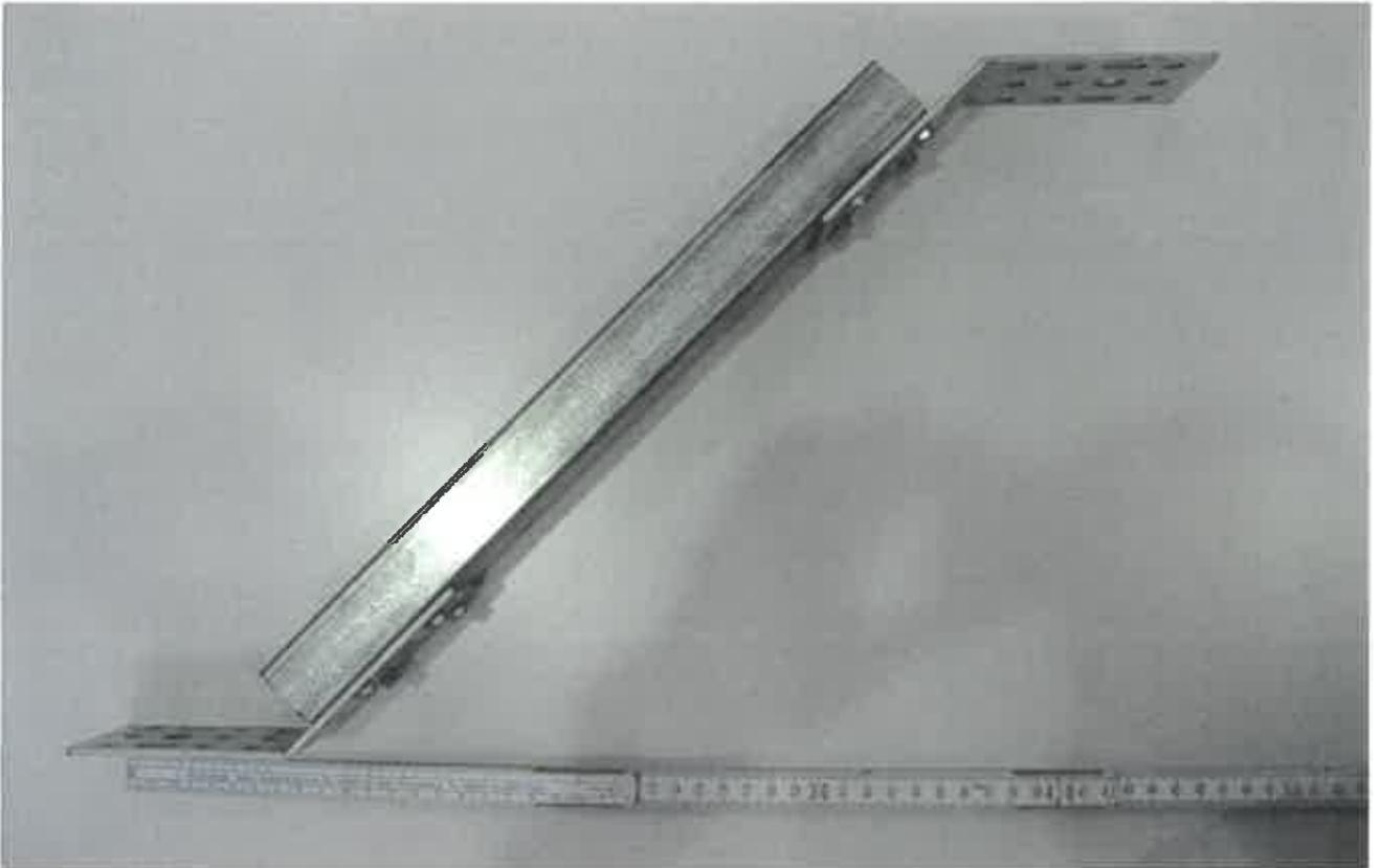
**Bild A.5.1:** Obere Verstrebung, Winkelprofile 135°,  $t_{\text{Winkel}} = 2,0$  mm, H101-0018-01 und Holm (60 x 30 x 2) verschraubt mit Blehschrauben je Seite 6 x 4,8 x 19, H422-0220
