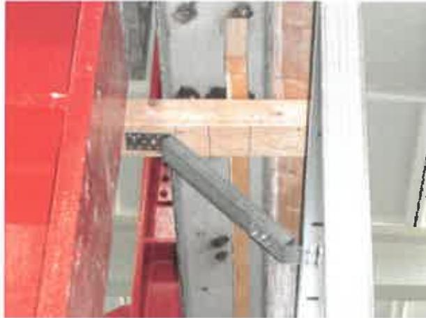
**Bild 1:** Zug- und druckfeste Montage der Wand am oberen Rand über zwei Winkel und ein Stahlprofil an die Querholme des Versuchsstandes
