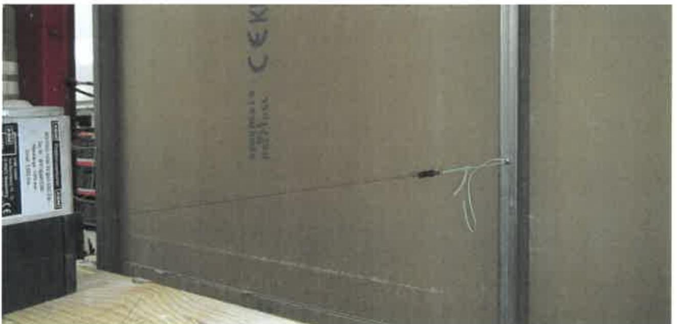
**Bild B.3.2:** Aufnahme der horizontalen Verformungen mittels Seilzugaufnehmern. Die grüne "Messschnur" wurde direkt mit den Profilen verschraubt
