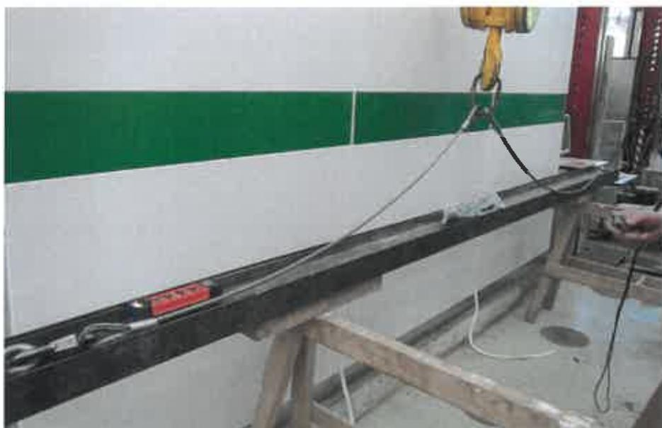
**Bild B.2.2:** Holmlast in 90 cm Höhe über ein  $l = 4,0$  m langes Doppel-T-Profil. Vor dem Versuch muss das Doppel-T-Profil infolge des hohen Eigengewichtes im Kran gesichert werden
