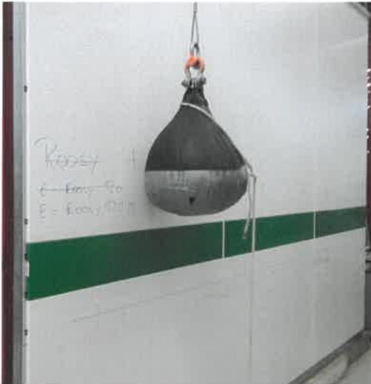
**Bild 4:** Versuchsaufbau der Pendelschlagprüfung,  $h = 1,50$  m, an der Trennwand
