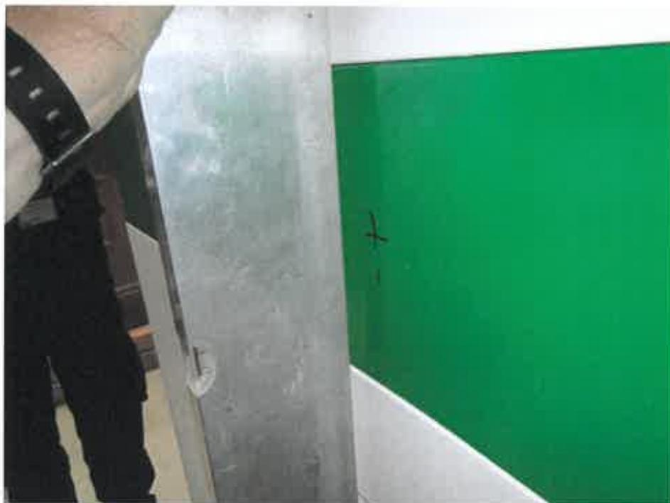
**Bild B.10.2:** Teilversuch, Pendelschlagversuch, Pendelschlagversuch direkt auf die Beplankung (Installationspanel) zwischen den Pfosten Nr. 1 und Nr. 2, an der linken Seite der Wand. Auftreffhöhe, gemäß DIN 4103-1,  $h = 1,15$  m. Pendelfallhöhe  $1 \times h = 70$  cm, Aufprallenergie  $1 \times E = 350$  Nm. Verformungskontrolle mit Richtscheid,  $\Delta w = 15$  mm
