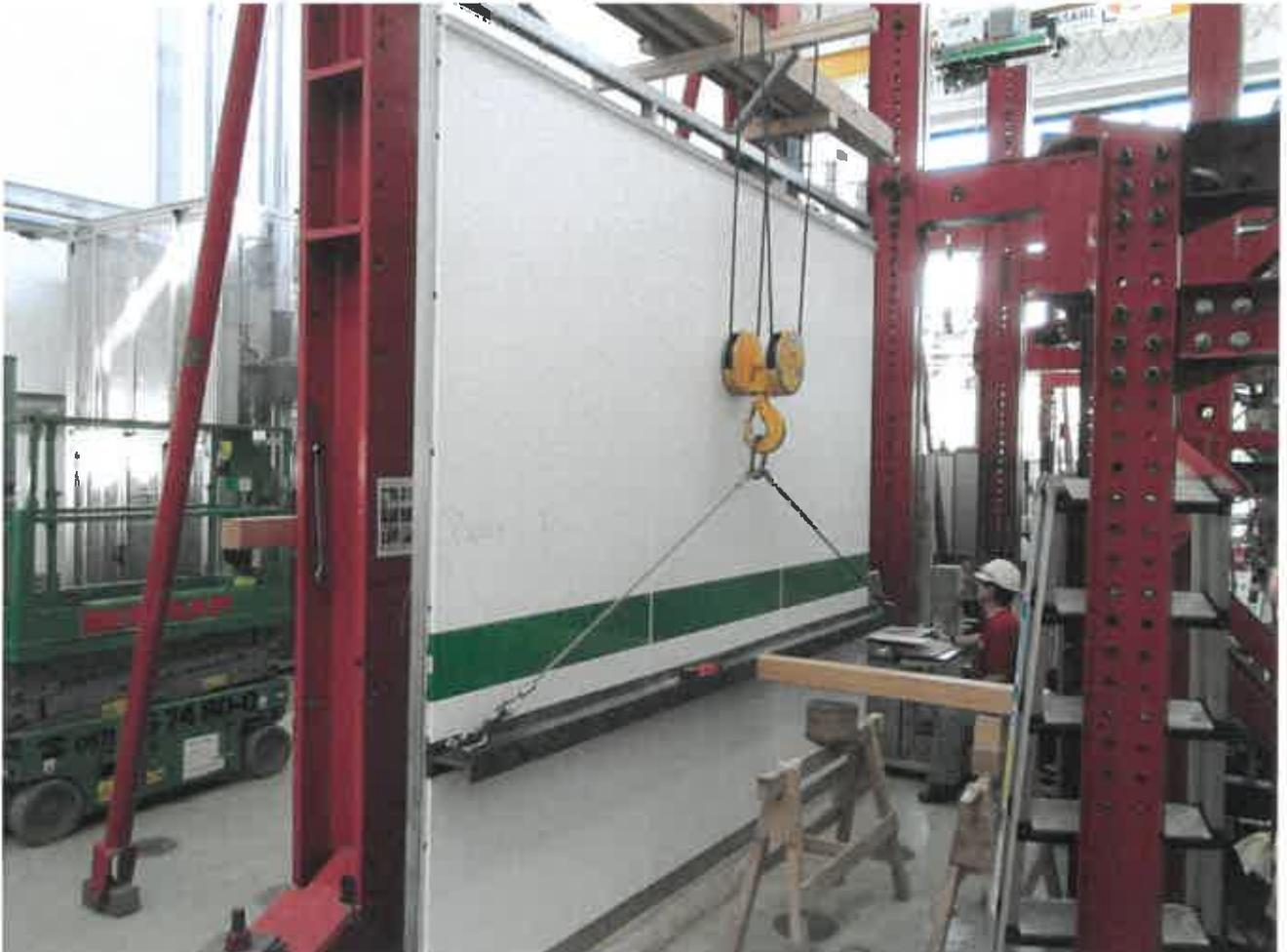
**Bild B.2.1:** Versuch Roosy 001, Holmlast in 90 cm Höhe, Biegeprüfung im elastischen Tragbereich der Stahlprofile
