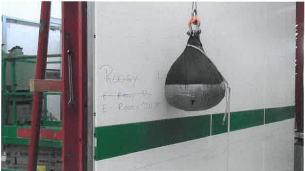
**Bild B.5.2:** Teilversuch, Pendelschlagversuch, Pendelschlagversuch direkt auf die Bepunktung zwischen den Pfosten Nr. 1 und Nr. 2, an der linken Seite der Wand. Auftreffhöhe, gemäß ETAG 003,  $h = 1,50$  m. Pendelfallhöhe  $3 \times h = 24$  cm, Aufprallenergie  $3 \times E = 120$  Nm und Pendelfallhöhe  $1 \times h = 40$  cm, Aufprallenergie  $1 \times E = 200$  Nm
