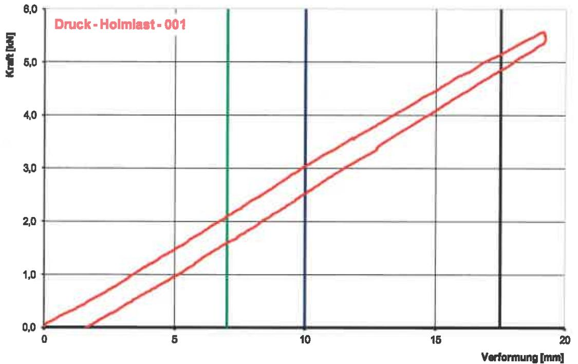
Bild C.3.1: Kraft-Weg Diagramm zu Versuch 001. Zusätzlich sind noch die Verformungsgrenzen  $H/200$  (schwarze Linie),  $H/350$  (blaue Linie) und  $H/500$  (grüne Linie) eingetragen
