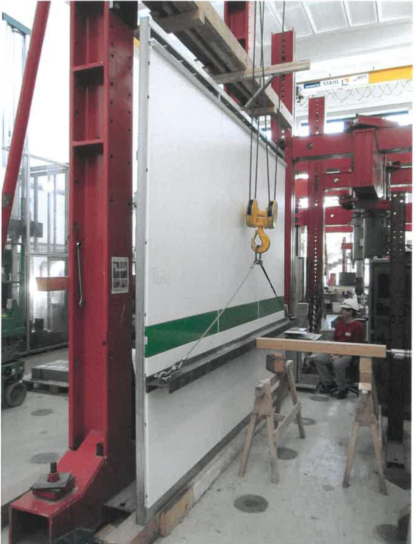
**Bild B.4:** Ende, Biegeversuch Roosy 001, die Last beträgt ca. 5,0 kN. Die horizontale Verformung beträgt ca.  $w = 30$  mm
