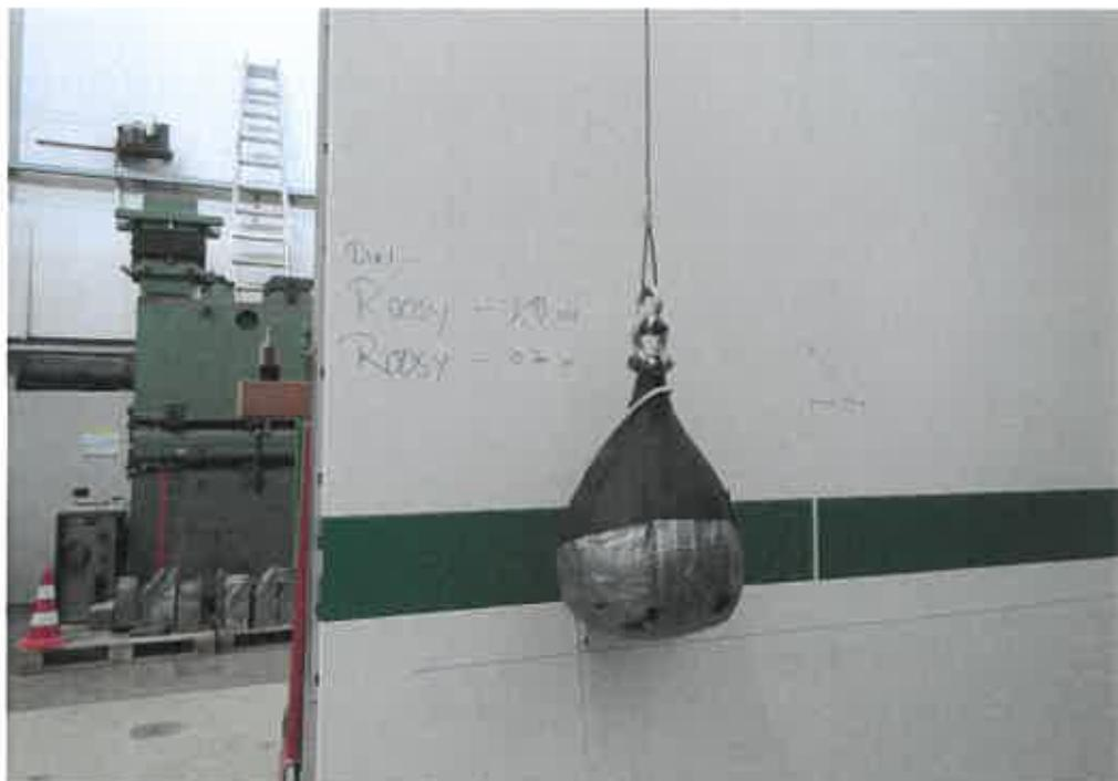
**Bild B.9.2:** Teilversuch, Pendelschlagversuch, Pendelschlagversuch direkt auf die Beplankung (Installationspanel) zwischen den Pfosten Nr. 1 und Nr. 2, an der linken Seite der Wand. Auftreffhöhe, gemäß DIN 4103-1,  $h = 1,15$  m. Pendelfallhöhe  $1 \times h = 70$  cm, Aufprallenergie  $1 \times E = 350$  Nm
