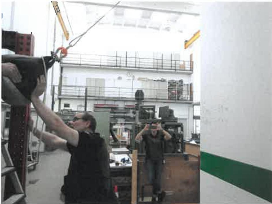
**Bild B.10.1:** Teilversuch, Pendelschlagversuch, Pendelschlagversuch direkt auf die Beplankung (Installationspanel) zwischen den Pfosten Nr. 1 und Nr. 2, an der linken Seite der Wand. Auftreffhöhe, gemäß DIN 4103-1,  $h = 1,15$  m. Pendelfallhöhe  $1 \times h = 70$  cm, Aufprallenergie  $1 \times E = 350$  Nm
