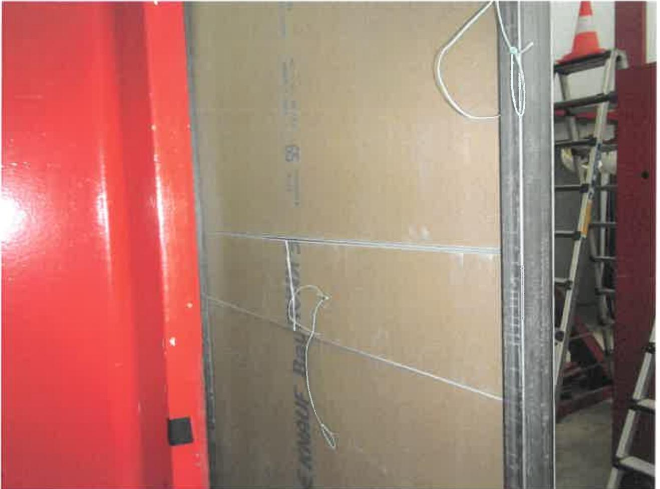
**Bild B.11:** Teilversuch, Pendelschlagversuch, Pendelschlagversuch direkt auf die Beplankung (Installationspanel) zwischen den Pfosten Nr. 1 und Nr. 2, an der linken Seite der Wand. Auftreffhöhe gemäß DIN 4103-1,  $h = 1,15$  m. Pendelfallhöhe  $1 \times h = 70$  cm, Aufprallenergie  $1 \times E = 350$  Nm. Verformungskontrolle mit Richtscheid,  $\Delta w = 15$  mm. Bruch der GKB-Beplankung im Installationspanel auf der Rückseite der Wand
