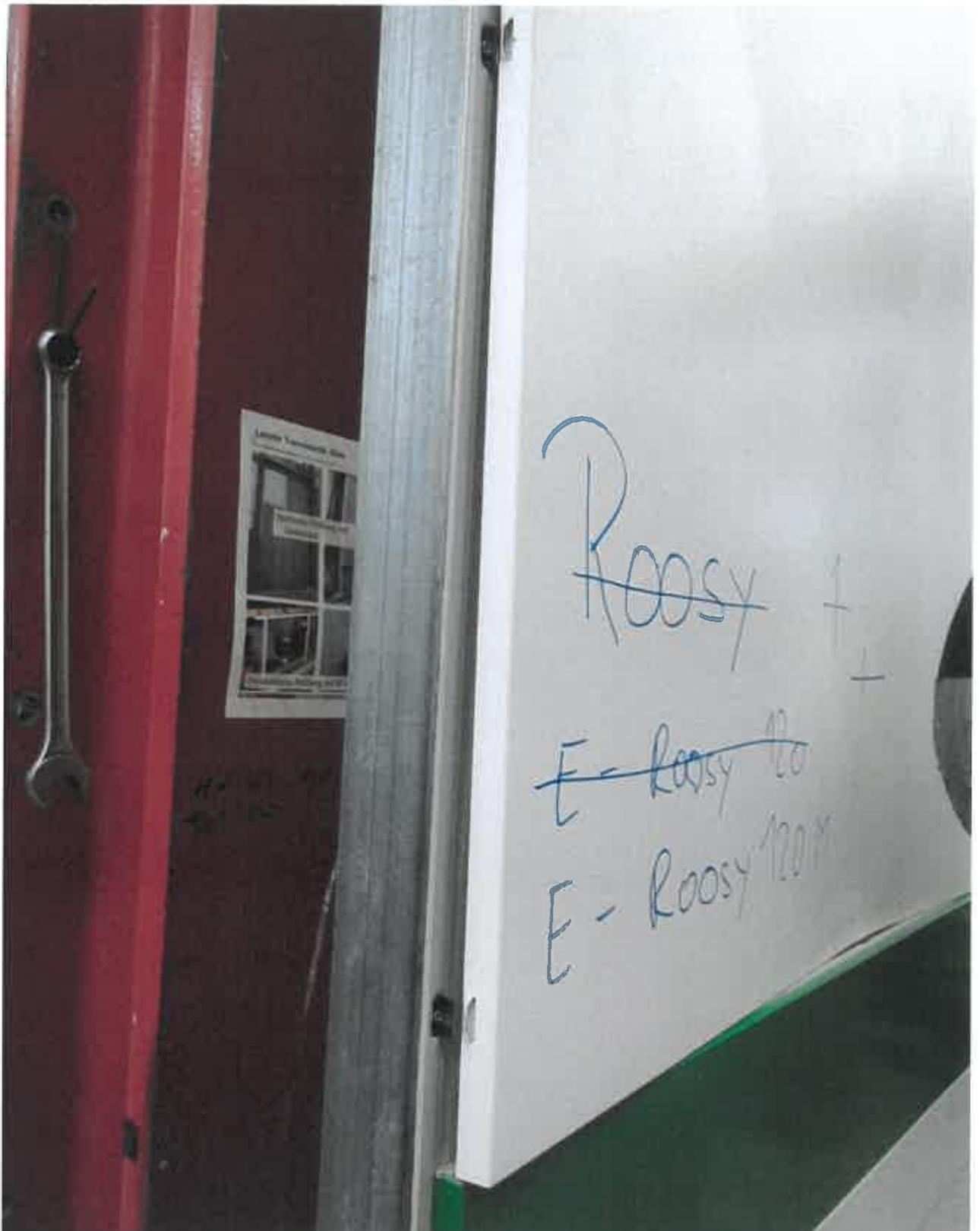
**Bild B.6:** Teilversuch, Pendelschlagversuch, Pendelschlagversuch direkt auf die Beplankung zwischen den Pfosten Nr. 1 und Nr. 2, an der linken Seite der Wand. Auftreffhöhe, gemäß ETAG 003,  $h = 1,50$  m. Pendelfallhöhe  $1 \times h = 40$  cm, Aufprallenergie  $1 \times E = 200$  Nm. Zwei Befestigungsklammern am linken Rand der Beplankung haben sich gelöst
