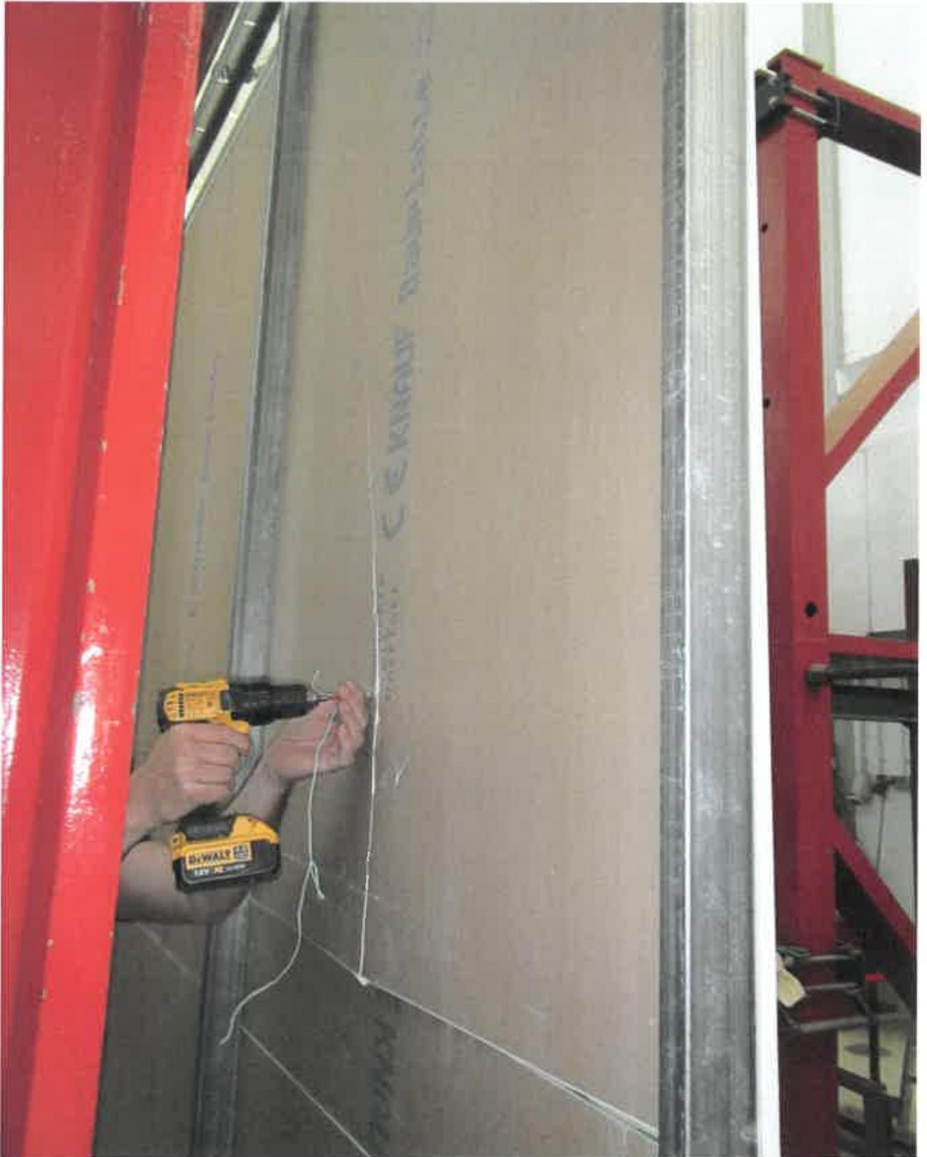
**Bild B.7:** Teilversuch, Pendelschlagversuch, Pendelschlagversuch direkt auf die Beplankung zwischen den Pfosten Nr. 1 und Nr. 2, an der linken Seite der Wand. Auftreffhöhe, gemäß ETAG 003,  $h = 1,50$  m. Pendelfallhöhe  $1 \times h = 40$  cm, Aufprallenergie  $1 \times E = 200$  Nm. Die GKB-Beplankung ist in der Mitte gebrochen
