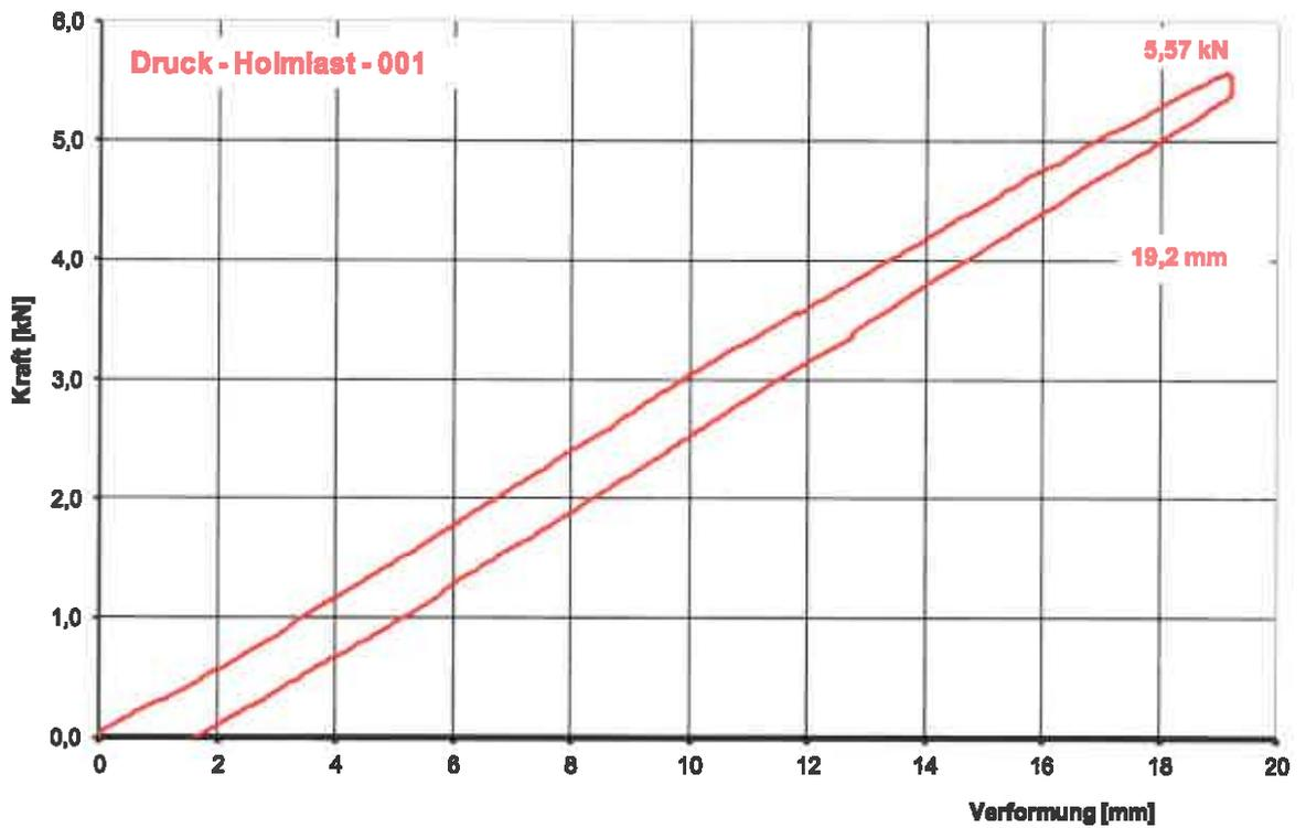
Bild C.2: Kraft-Weg Diagramm zu Versuch 001
