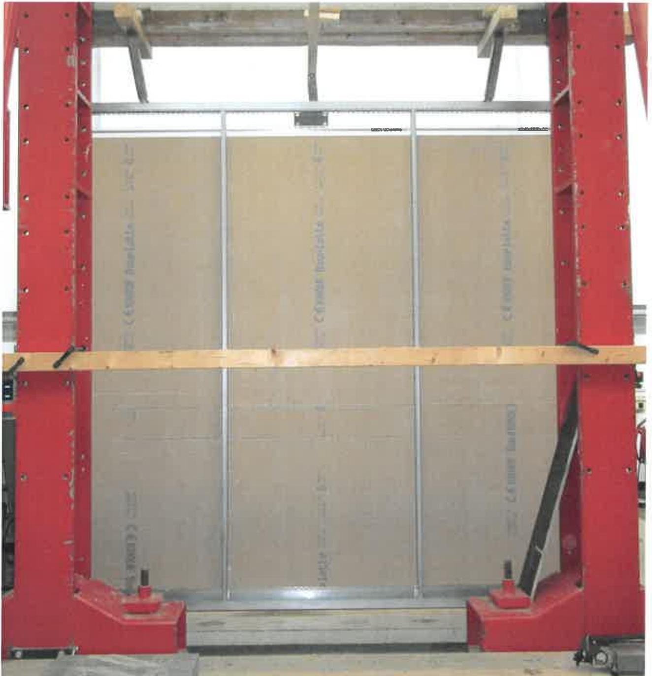
**Bild A.8:** Der Rückseite Rand der Wand bleibt unbedeckt. Am oberen Rand der Bepunktung ist eine Schiene verschraubt, an der eine abgehängte Decke befestigt werden kann. Auf halber Wandhöhe ist ein Holzbalken montiert. An diesem Holzbalken werden im Versuch die Wegaufnehmer angebracht
