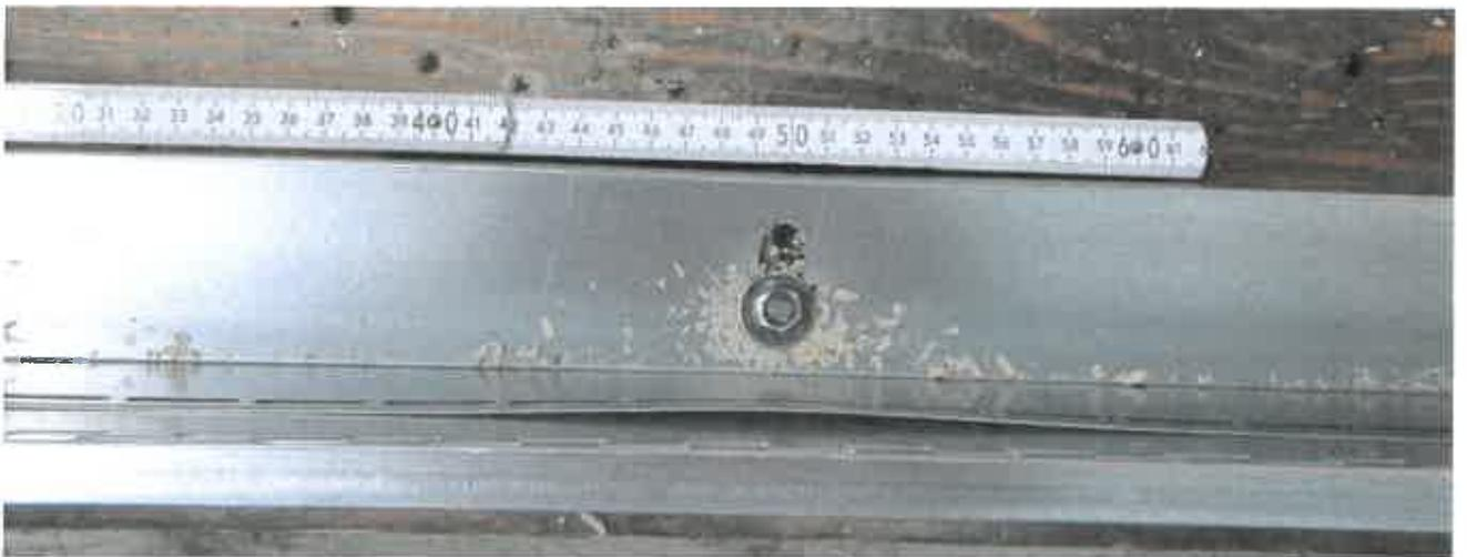
**Bild A.2.2:** Montage der U-Bodenschiene durch den Auftraggeber auf der Fußbohle (#16/16), Versuchsstand der MPA Braunschweig. Abstand der Verschraubung  $e \approx 50$  cm. Verschraubung mit Sechskantschraube 8 x 40, H422-0730
