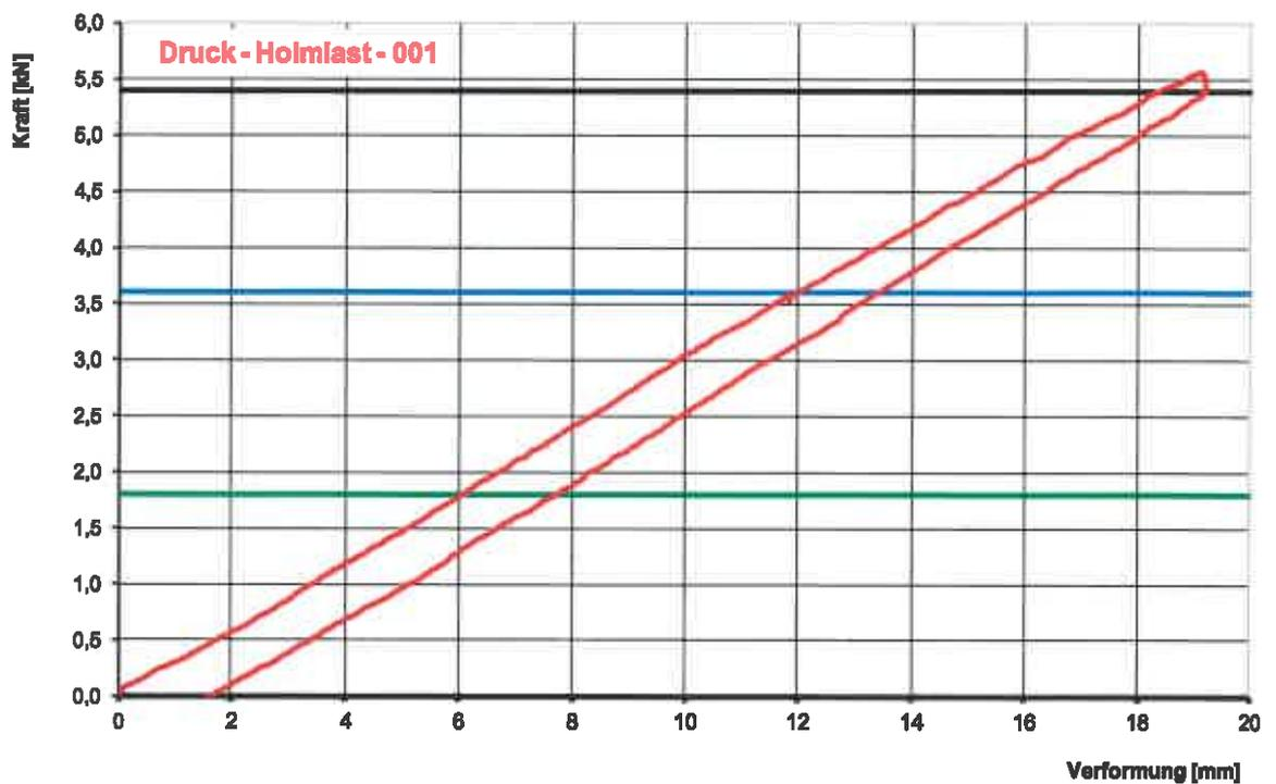
Bild C.3.2: Kraft-Weg Diagramm zu Versuch 001. Zusätzlich sind noch die Kräfte zu Einbaubereich 1 (grüne Linie), Einbaubereich 2 (blaue Linie) und zur Traglast (schwarze Linie) eingetragen.
