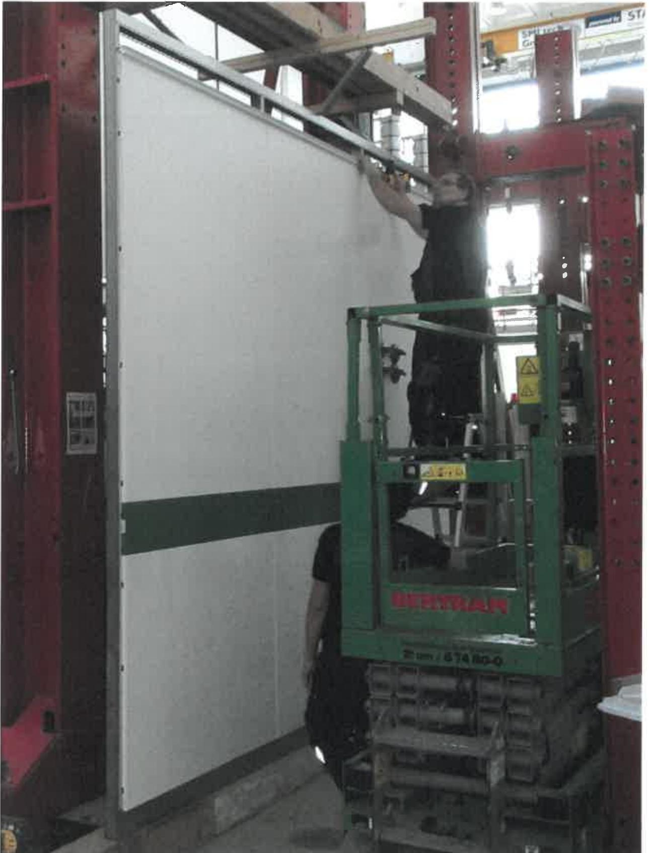
**Bild A.7:** Die Vorderseite der Wand ist bereits fertig montiert. Wandelement oben, 1.193 mm x 1.755 mm, Install-Element 1.193 mm x 200 mm und Wandelement unten 1.193 mm x 950 mm
