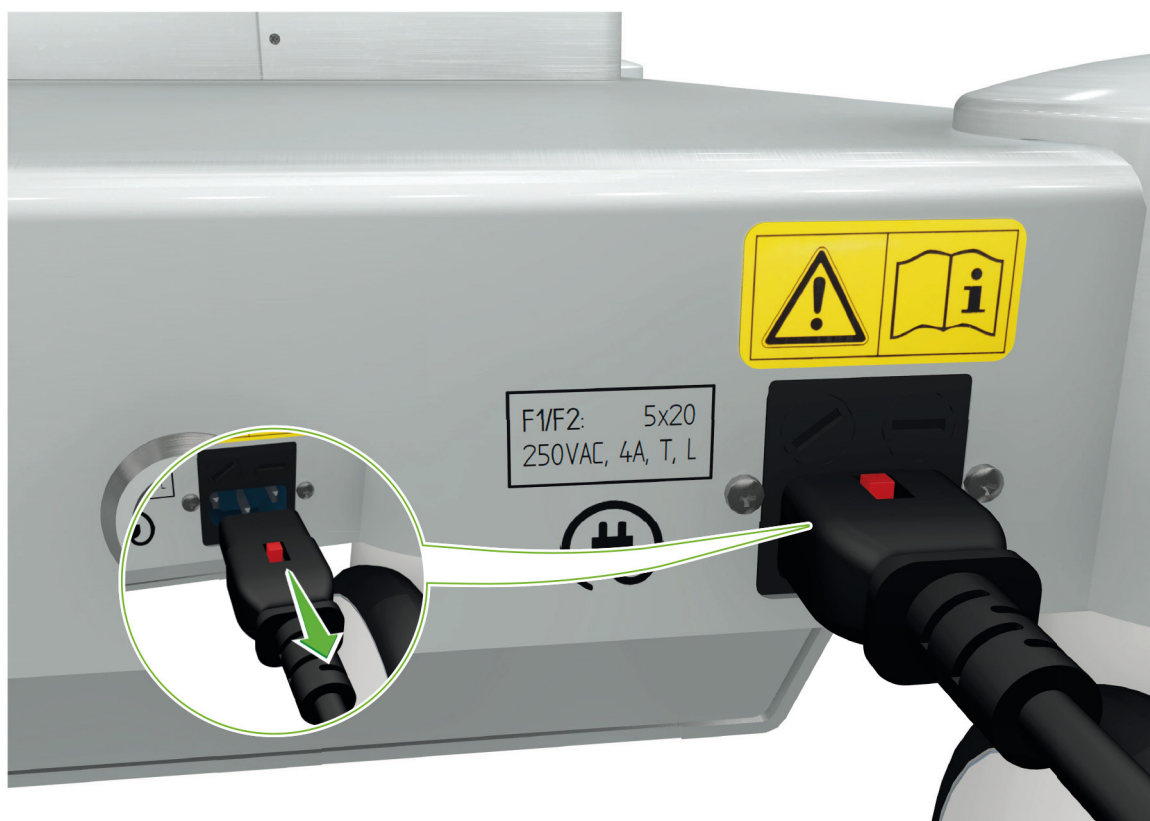
Fig 18: Toma de corriente (enchufe con dispositivo de seguridad de extracción)
