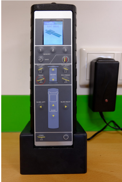
Fig. 21: Estación de carga con enchufe de red para el conmutador manual por infrarrojos
