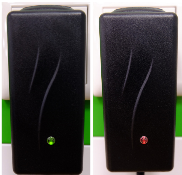
Fig. 20: Fuente de alimentación del conmutador manual por infrarrojos
