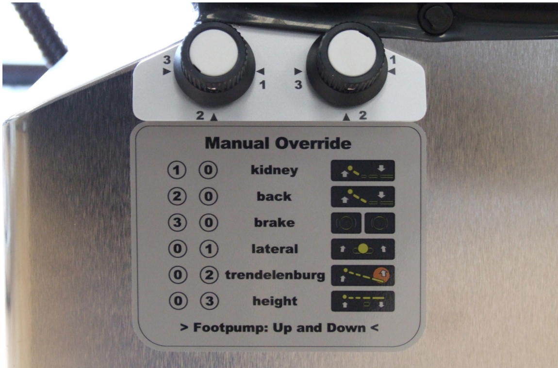
Fig. 24 : Système de sécurité avec sélecteur de fonction gauche et droit
