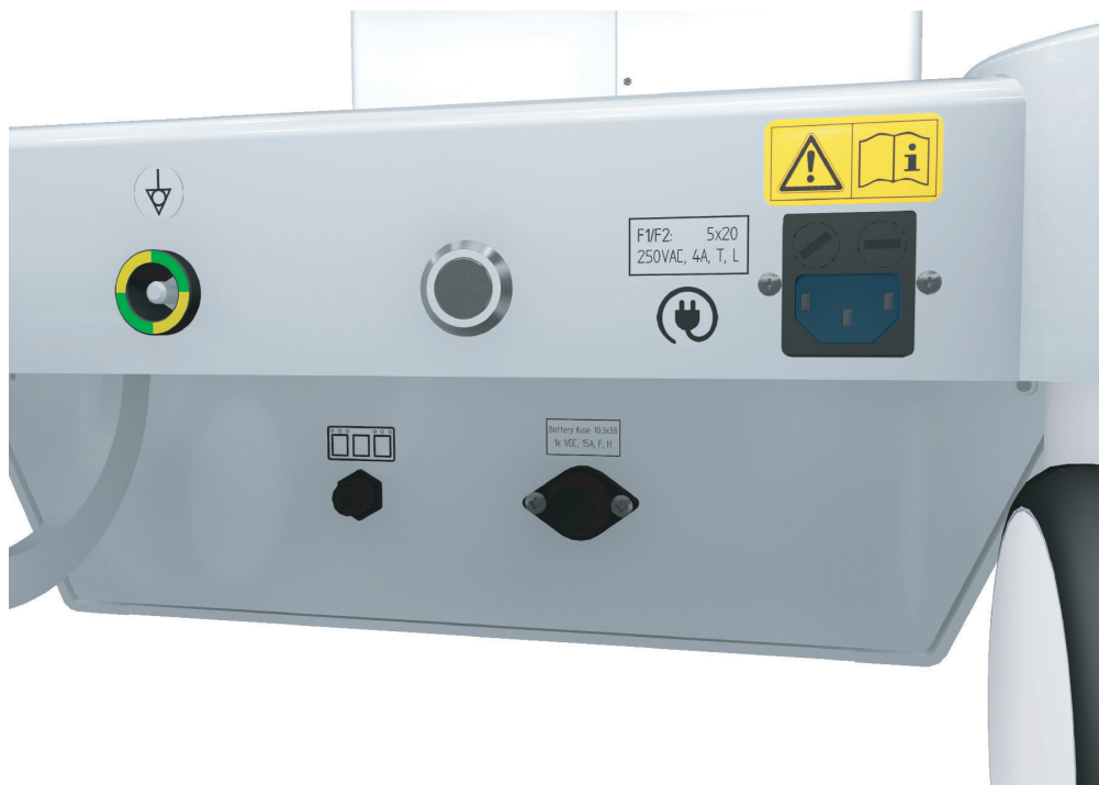
Fig. 7 : Interrupteur principal et raccordements sur le socle
