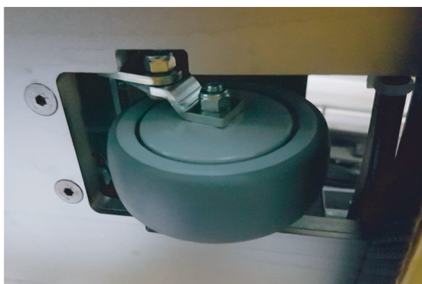
Fig. 8 : Cinquième roue centrée sous le socle
