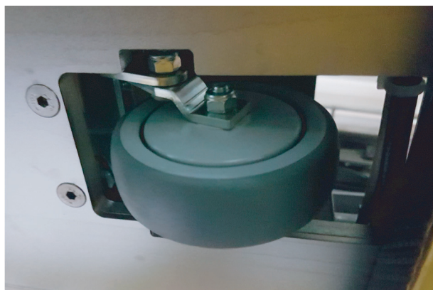
Fig. 12 : Cinquième roue centrée sous le socle
