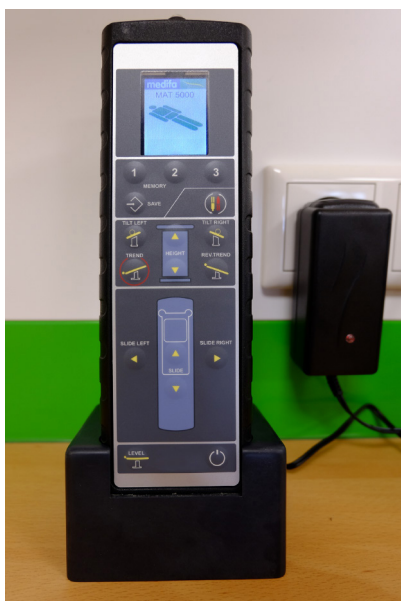
Fig. 21 : Station de charge avec fiche secteur pour la télécommande à infrarouge
