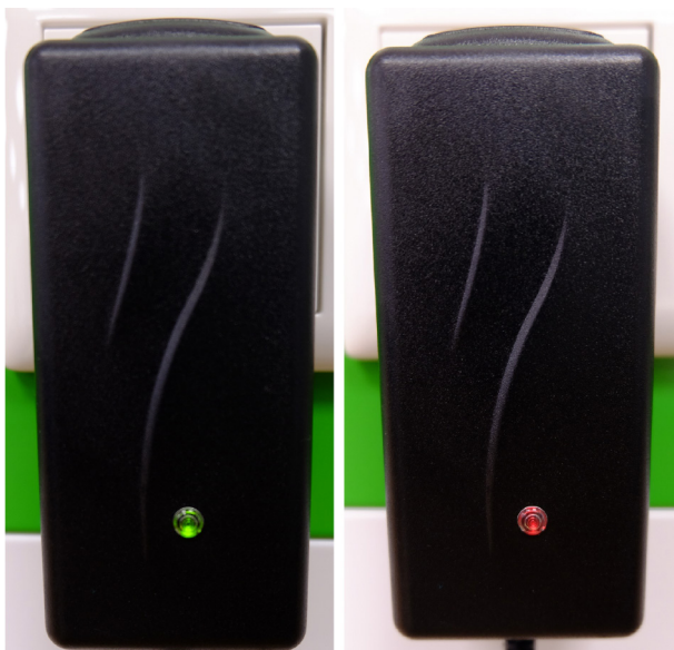
Fig. 20 : Bloc d'alimentation de la télécommande infrarouge
