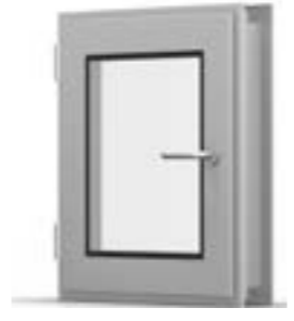
Durchreiche Flügel Fenster – Edelstahlrahmen mit ESG-Glasfenster, Öffnung einseitig, ohne Verriegelung, geeignet für Räume mit geringeren hygienischen Anforderungen
