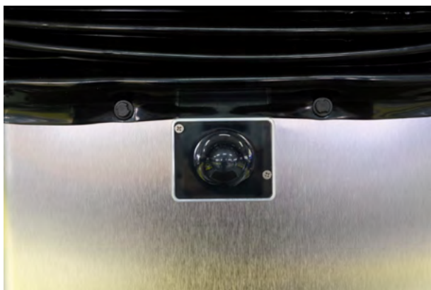
Fig. 3: Ricevitore a infrarossi sulla colonna di sollevamento
