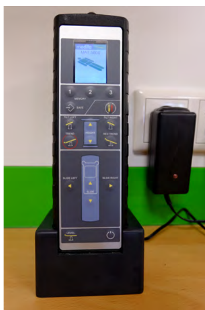
Fig. 12: Stazione di ricarica con spina di alimentazione per l'interruttore manuale a infrarossi
