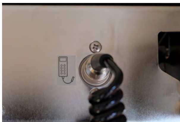
Fig. 4: Conexión para el conmutador manual
