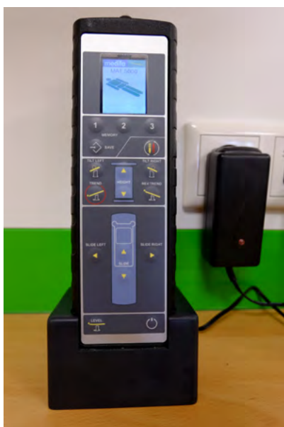
Fig. 12: Estación de carga con enchufe de red para el conmutador manual por infrarrojos
