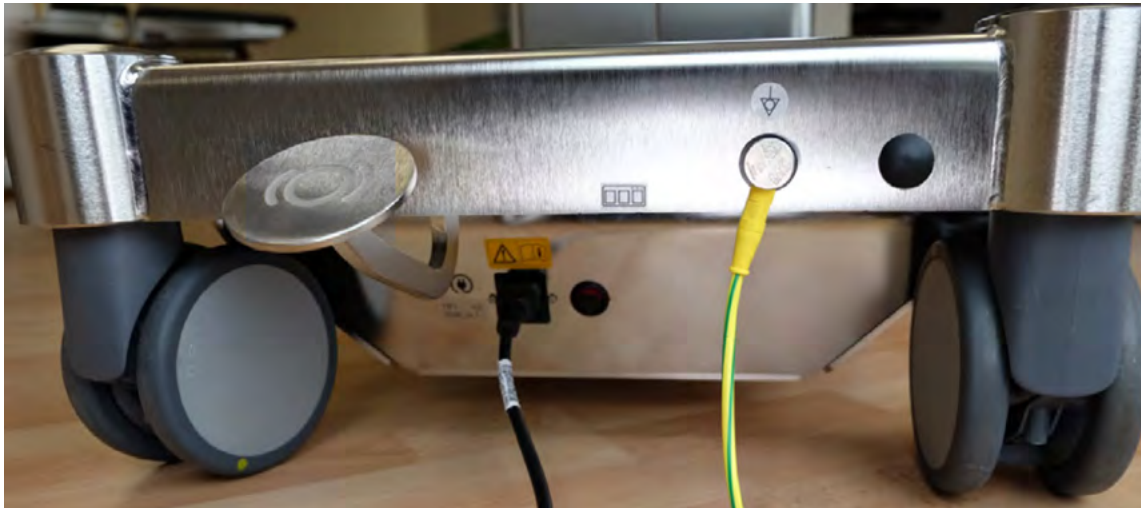
Fig. 5: Interruptor principal y conexiones en la base
