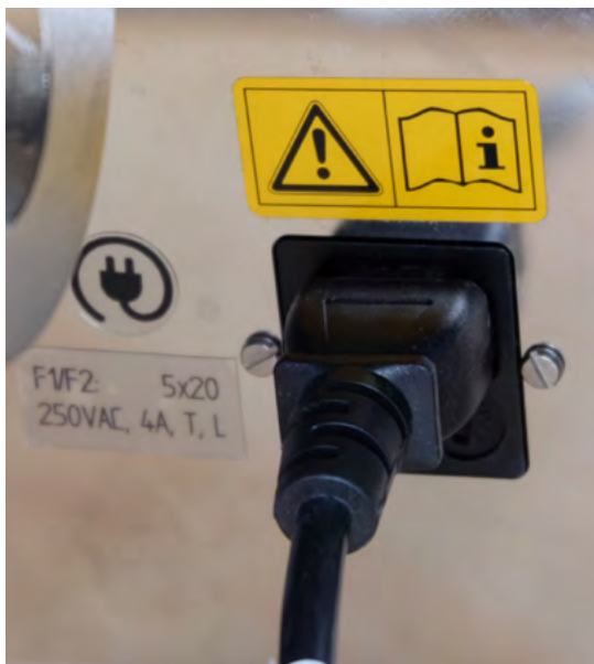
Fig. 10: Toma de conexión a la red
