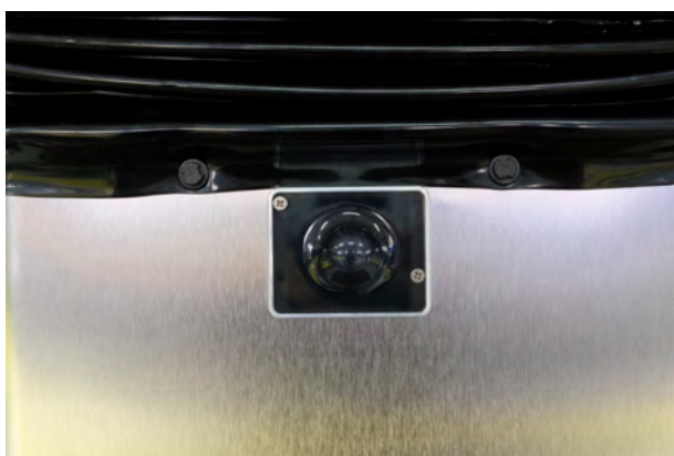
Fig. 3: Receptor de infrarrojos en la columna de elevación
