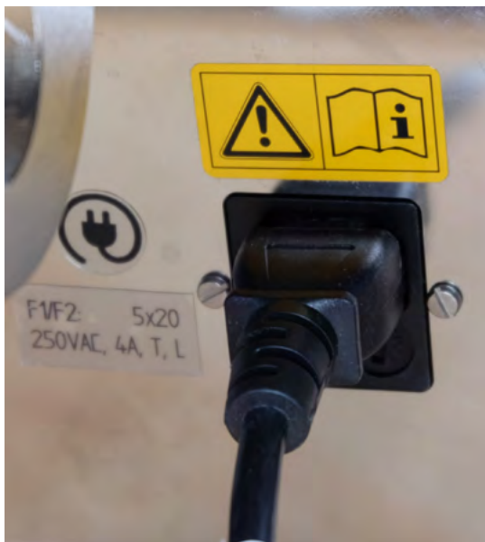
Fig. 10 : Prise de raccordement au réseau
