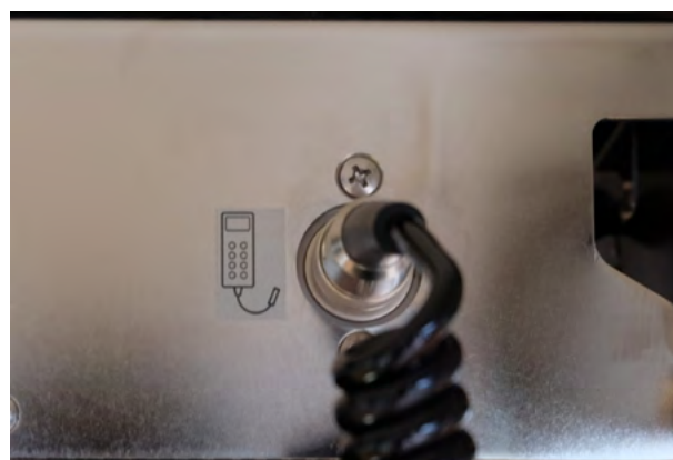
Fig. 4 : Raccordement pour la commande manuelle
