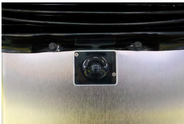
Abb. 3: Infrarot-Empfänger an der Hubsäule
