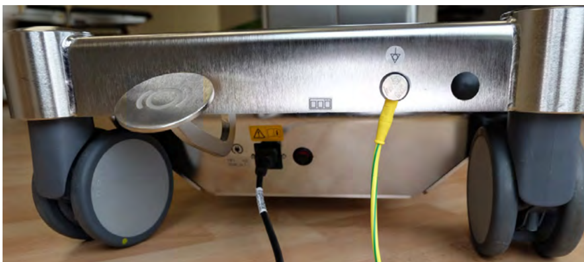
Abb. 5: Hauptschalter und Anschlüsse am Sockel
